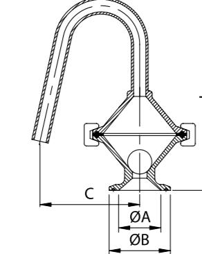
缓解储罐或管道上的过载气压。
